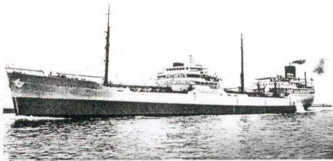
De „Ameland”, gebouwd door P. Smit Jr., Rotterdam voor de Stoomvaart Mij. Rotterdam. De tanker mat 12.159 brt, 18.234 dwt, lengte 169,38 m over alles, breedte 21,16 m, holte 11,89 m, uitgerust met een 7500 pk stoomturbine-installatie voor een dienstvaart van 14,5 knoop. De „Ameland” was een zusterschip van de „K”-klasse tankers van Shell. Foto Stoomvaart Mij. Rotterdam.
