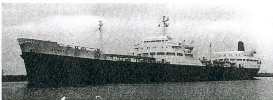
De „Acmaea”, gebouwd in 1959 door P. Smit Jr., Rotterdam voor Shell Tankers N.V., 's-Gravenhage. De tanker mat 12.222 brt, 18.090 dwt, lengte 170,41 m over alles, breedte 21,16 m, holte 11,89 m, diepgang 9,07 m, voortgestuwd door een 8750 pk 7 cil. 2-takt B&W diesel voor een dienstnelheid van 14,5 knoop. Foto J. Mol, Assendelft.
